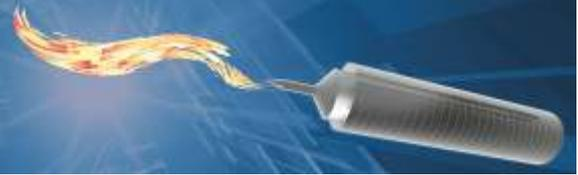
Temperaturdatenlogger für Thermoelemente bis 8 Kanäle, beständig bis 130 ° C, mit Universalanschlüssen für Thermoelemente. Der Einsatzbereich reicht von -60 ° C bis 130 ° C Ofentemperatur.
