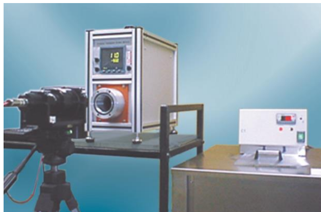
Fig. 25: Contrôle d'un corps noir à l'aide d'un pyromètre de transfert (Tirrat LT, Fluke Process Instruments)
