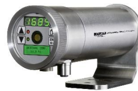
Fig. 19: Pyromètre Endurance (Fluke Process Instruments) à optique focalisable. L'ajustement de la distance de focalisation doit être fait sur site. De plus, la visée se fait à travers l'objectif (visée reflex) permettant un positionnement précis du spot de mesure sur la cible quelque soit la distance de mesure.
