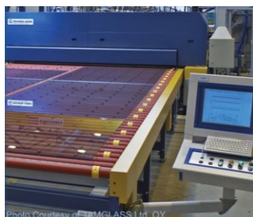
Fig. 13: De sa phase liquide jusqu'à l'obtention du produit fini, un suivi de température précis assure l'acquisition et le maintien des propriétés souhaitées. La figure présente une ligne de trempe de feuilles de verre pour le bâtiment.
